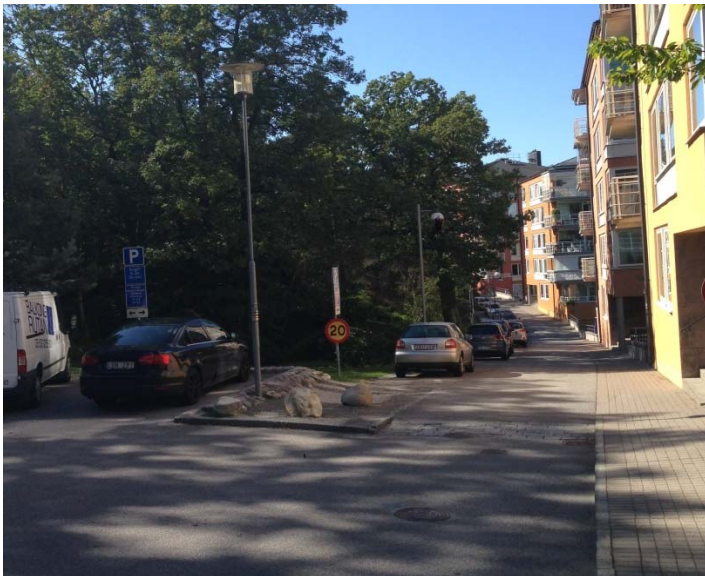
Figur 2. Refug och belysningsstolpe som måste tas bort för att möjliggöra backvändning längs Fabrikörvägen.
